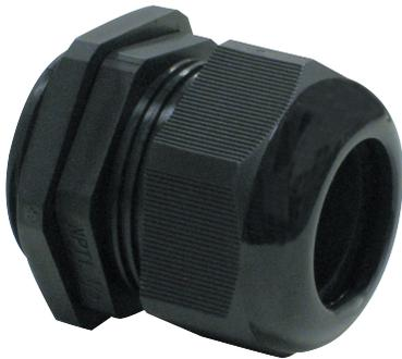
**Aplicaciones:** Los conectores glándula nylon es un conector universal a prueba de líquidos, durable, fácil de montar, con alivio de esfuerzo y rosca NPT; ideal para todos los tipos de maquinaria y equipo, incluyendo la automatización, el control de movimiento y la robótica. El diseño resistente proporciona una fuerza de arranque y alivio de esfuerzo confiable.
